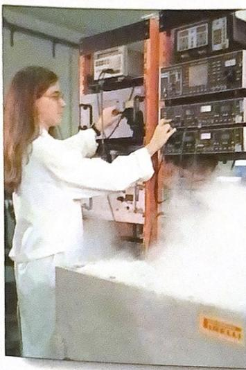
**LABORATORIO** Esperimenti con azoto liquido che consentono di portare i superconduttori a -196 gradi di temperatura
